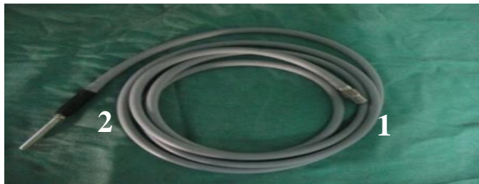
1 : Extrémité optique 2 : Extrémité source de lumière
