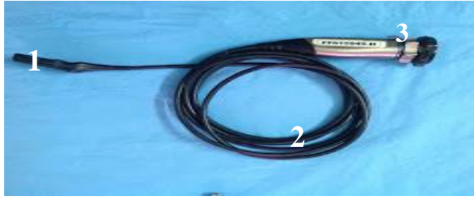
1: Capteur photosensible; 2 : Câble à fibre optique; 3: Tête de caméra
